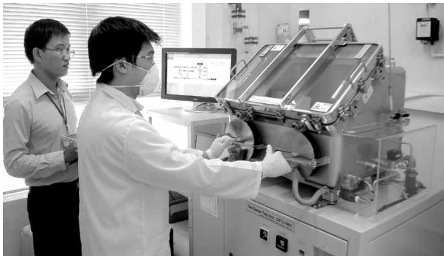
▲ Hệ thống kiểm định, hiệu chuẩn thiết bị đo khí cầm tay
